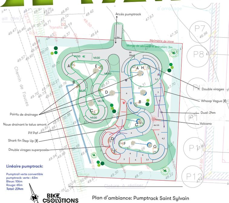
Rien ne doit être laissé au hasard : les rayons de courbe des virages relevés, l'espacement et le gabarit des bosses... La précision est essentielle ! Une largeur restreinte, une épaisseur d'enrobé réduite, un rayon de courbe inadéquat sont autant de facteurs qui abaissent la qualité de l'ouvrage, sa durabilité et le plaisir de pratiquer.
